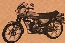
KS 50 watercooled 50 ccm, 6,25 PS (4,60 kW), 5 Gänge, HKZ-Anlage, Cockpit, Blinker, Leichtmetall-Druckguß-Rahmen, Alu-Druckguß-Räder, Scheibenbremse, "TT" (Bild) mit Cockpit-Verkleidung, Heckspoiler. Kl. 4, ab 16.
