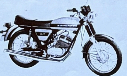
Motorrad KS 125 Sport Mit enormer Kraft. 125 ccm, 5 Gänge, 17 PS (12,51 kW), elektronische Zündanlage (HKZ), Doppelschleifen-Rahmen, 3fach verstellbare Federbeine, Cockpit, Blinkanlage. Kl. 1, ab 18.
