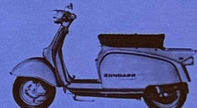
Roller R 50/RS 50 Super Coupé auf zwei Rädern. R 50 mit 2,9 PS und 3 Gängen, Handschaltung. Führerschein Klasse 5, ab 16. RS 50 Super 4,6 PS, 4 Gänge, Fußschaltung. Führerschein Kl. 4, ab 16.
