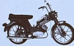
Mokick ZD 40 Neues, flottes Mokick. 50 ccm, 2,9 PS (2,13 kW), 3 Gänge, Fußschaltung, Kickstarter, Rohr-Druckguß-Rahmen, Alu-Druckguß-Laufräder, Cockpit, Doppelsitzbank. Führerschein Klasse 5, ab 16.
