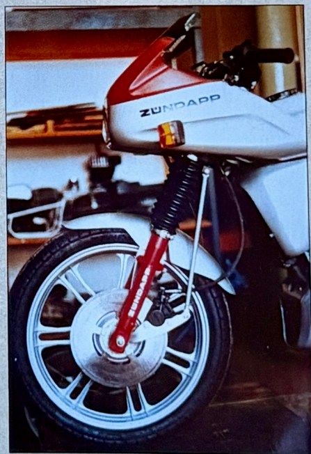
Mechanisches Anti-Dive-System an der TT 80 S.
