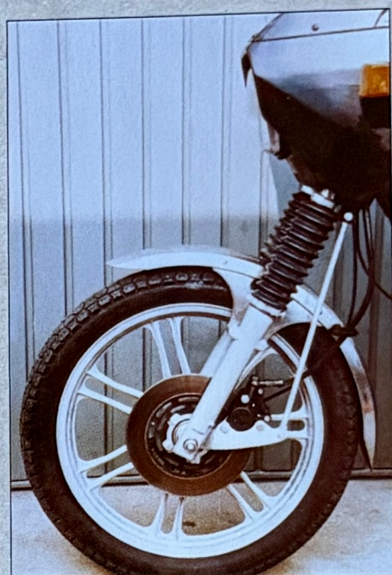
Mechanisches Anti-Dive-System am Modellversuchsträger Typ 540 L.
