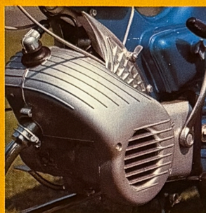
Dauerbrenner: Mokick C 50 Super, 2,9 PS, 3-Gang-Getriebe.
