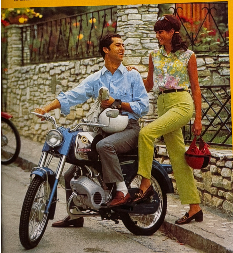
Mokick C 50 Sport, Bj. 1969, mit gebläse- oder auch luftgekühltem 2,9 PS-Motor.
