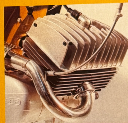
KS 50 Super Sport Typ 517-20 LR (hochgezogener Auspuff) von 1972 mit 6,25 PS und „Superthermzylinder“.
