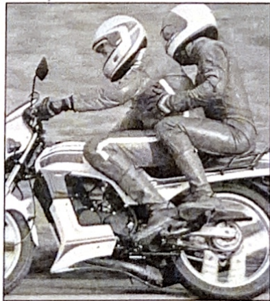
Wegen zu hoher Fußrasten wird die Tour für den Honda MBX-Beifahrer zur verkrampften Tortur. Sitzbank für zwei zu kurz
