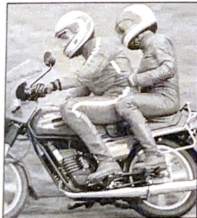
Entspanntes Fahren ist auch auf der Hercules RX 9 möglich. Bequeme Sitzbank und günstige Fußrasten-Position. Schlechte Lenkerform
