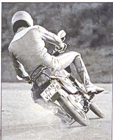
Die KTM 80 PL setzt in Linkskurven schon mit einer Person viel zu früh mit dem Hauptständer-Ausleger auf. Geschlossener Kettenkasten rechts
