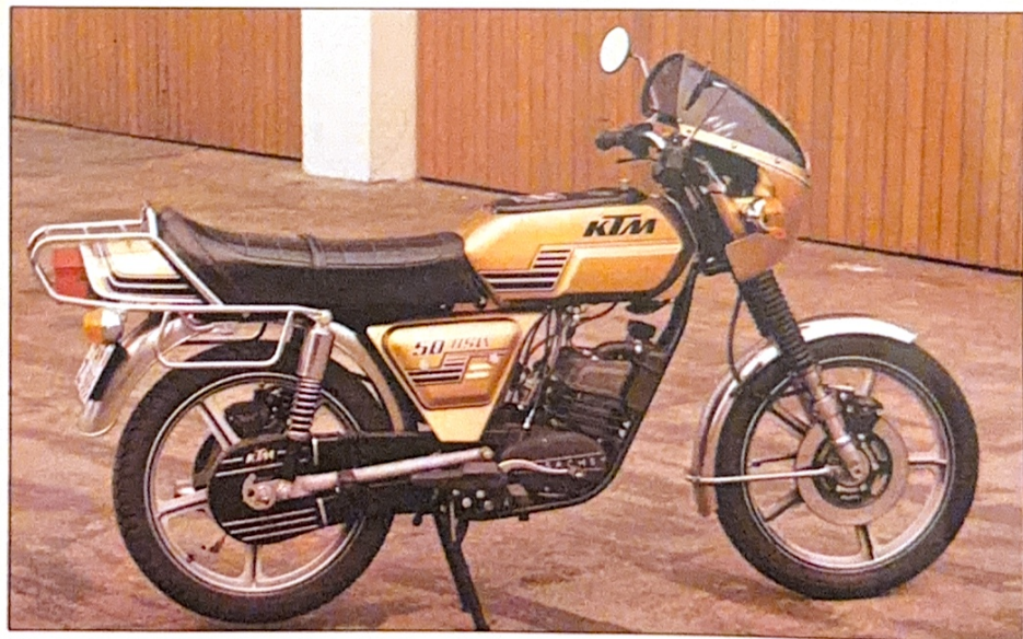
Die KTM 50 RSW. Beachtlich ist die vollständige Kapselung der Hinterradkette! Bereifung: 2,50–17/2,75–17. Hydraulische Scheibenbremsen vorn und hinten, Scheibendurchmesser 245 mm. Gewicht ca. 92 kg.
