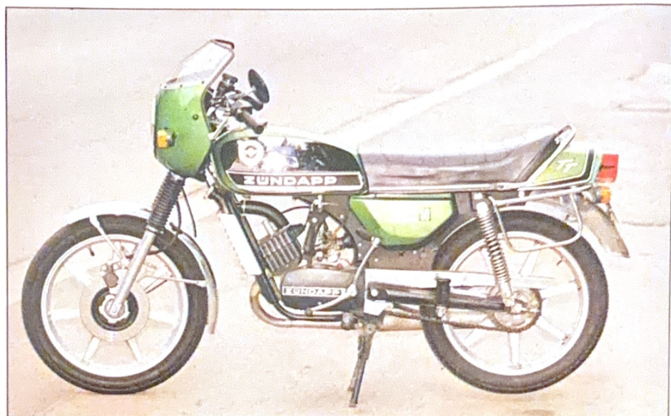
Die Zündapp KS 50 watercooled (TT), die wir mit auf die Südschleife nahmen. Bereifung 2,75–17. Vorne hydraulisch betätigte Scheibenbremse, hinten Leichtmetall-Vollnabenbremse. Gewicht ca. 84 kg.
