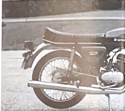
Seitenansicht: recht hoch ist die Zündapp; großer Tank, 18-Zoll-Räder, sehr tief liegend ist die Auspuffanlage.
