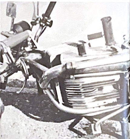
Motor der Hercules unten stark verrippt; Rohrunterzüge angeschraubt; Schleifspuren am Mittelständer.
