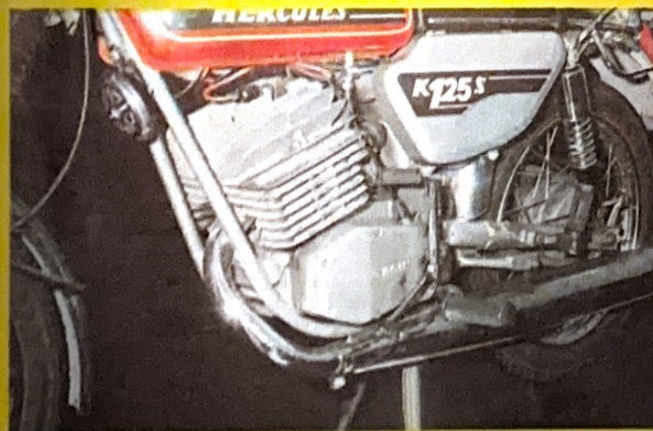
Die Motoren. Bei beiden Zylindern stellte das Schwirren der Kühlrippen ein Geräusch-
